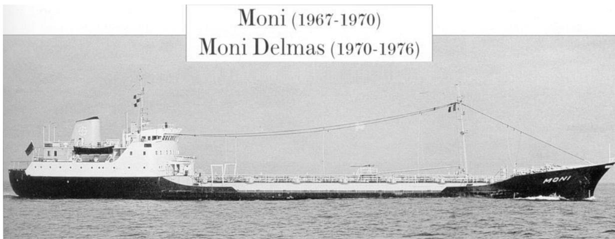
Tanker pour huiles et pétrole en vrac, type longitudinal, à coque soudée et passerelle arrière.
